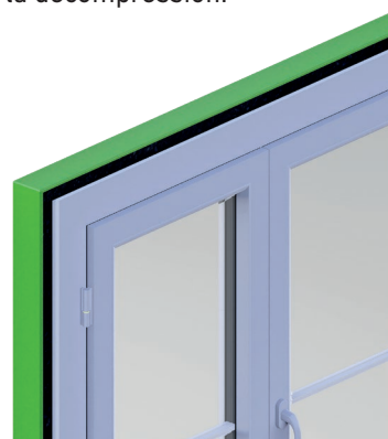
Figure 10 : Jonction angle – Pose en tunnel
